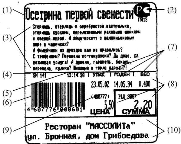
Рис. 5. Пример печати этикетки формата 2. Этикетка размером 58 x 60 мм, с препринтом. (1) – первая строка наименования товара шрифтом двойной высоты; (2) – логотип; (3) – 8 строк сообщения; (4) – порядковый номер этикетки; (5) – время печати; (6) – штрих-код; (7) – препринт; (8) – числовые значения веса, цены и стоимости; (9) – групповой код; (10) – поле текста “магазин”.
